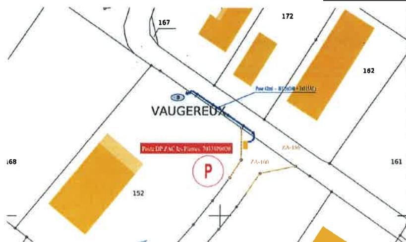
Plan ZA les Plantes : en bleu « réseau ENEDIS » souterrain
